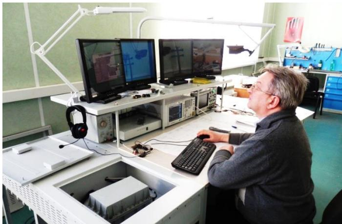
Рис. 3.3.6. Стенд для измерения задержек передачи видеoinформации
