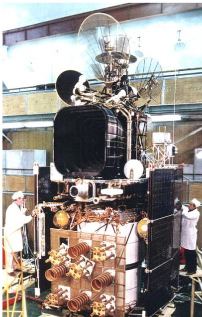
Рис. 1.2.14. Сборка КА «Электро» с аппаратурой «Метеорит-Планета»
