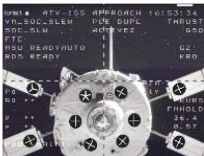
Рис. 3.4.3. Варианты реперов, включающие уголковые отражатели и катафоты
