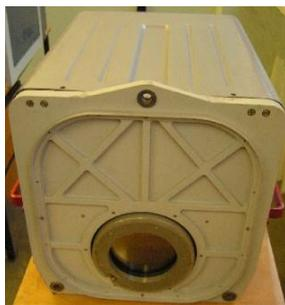
Рис. 1.2.25. Телевизионная камера высокой чёткости ЛР-103
