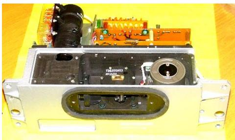
Рис. 1.2.12. Сканирующая ТВ камера аппаратуры «Метеор»
