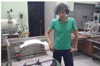
Рис. 3.1.2. Испытания на вибропрочность моноблока для скафандра
