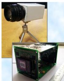
Рис. 3.2.16. Макетный образец ТВ камеры на ПЗС матрице формата  $1920 \times 1080$
