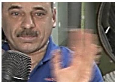
Рис. 1.1.2. Влияние чересстрочной развёртки на передачу подвижных изображений
