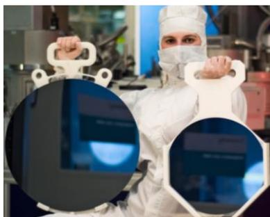
Рис. 4.3.1. Кремниевые пластины диаметром 450 мм и 300 мм
