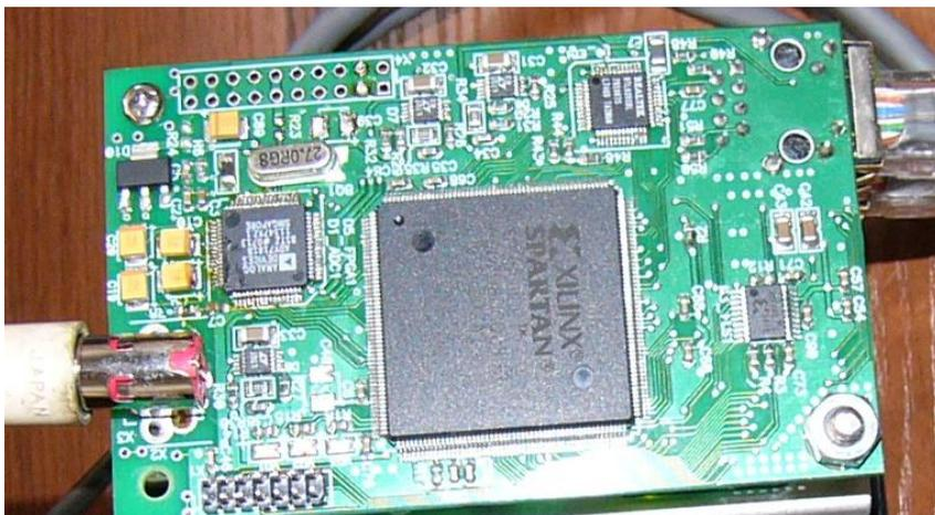
Рис. 3.3.1. Опытный образец кодера *MPEG-2*
